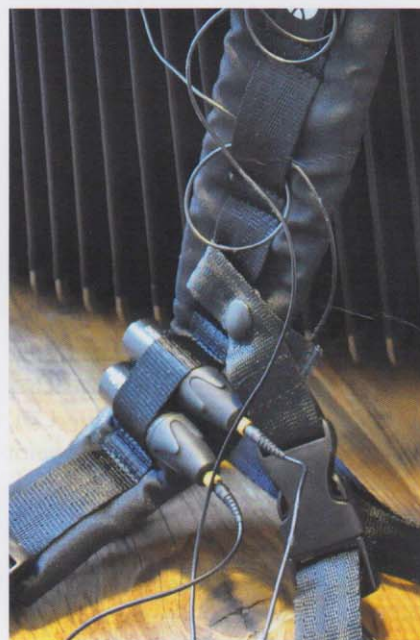
Die beiden Speiseadapter lassen sich an den Gurtschlaufen befestigen. Hilfreich ist es, die Mikrofonkabel zur Zugentlastung einmal durch eine weiter oben liegende Lasche zu ziehen.
