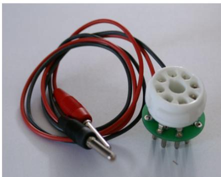
Eine Alternative stellt die Verwendung eines Messadapters da, der keinen Umbau des Verstärkers erfordert, aber dennoch die gleichen Messwerte liefert. Eine einfache, aber effektive Ausführung eines solchen Adapters ist auf dem Bild links unten zu sehen.
