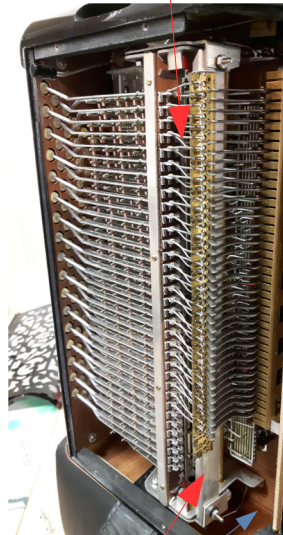
Metallschieber für die Einzeltöne
