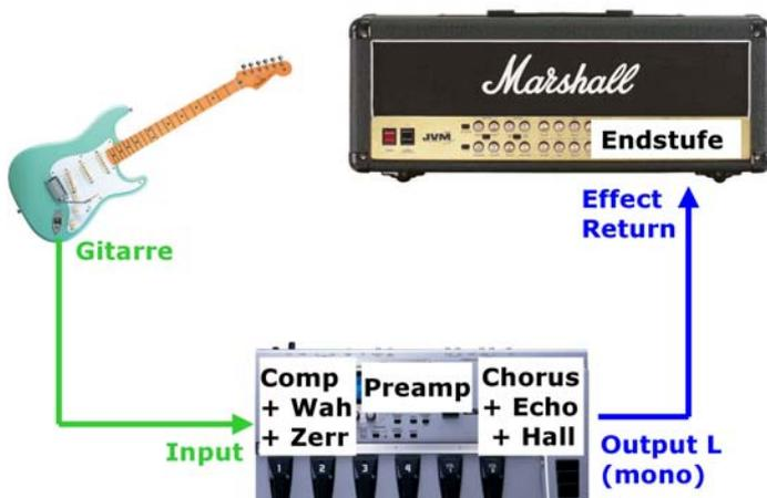
Die korrekte GT-10 OUTPUT-Einstellung für Verkabelung 2:
