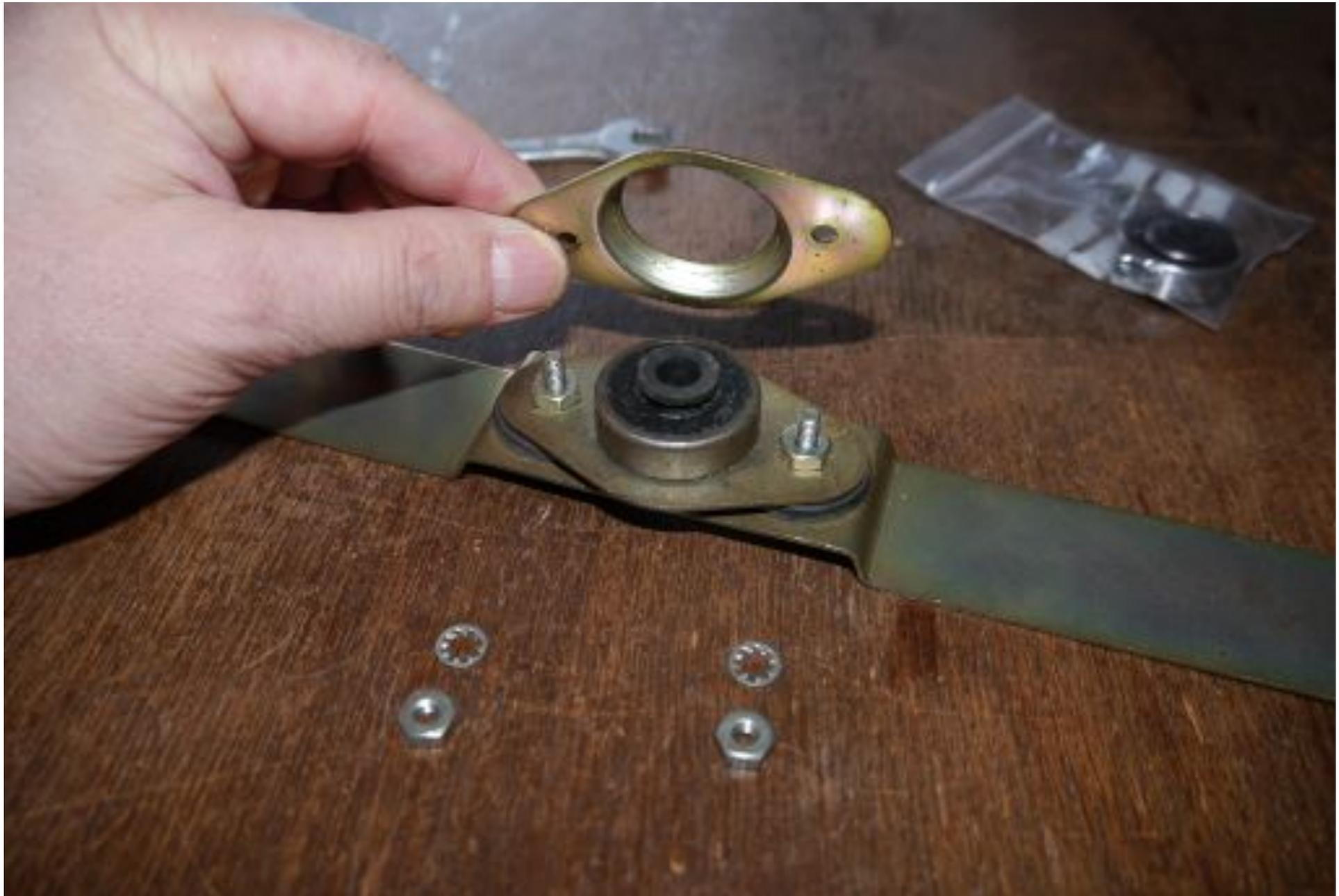
**Aufpassen, dass die Kugellagerhalterungen nicht verkantet sind, sondern parallel sind**
