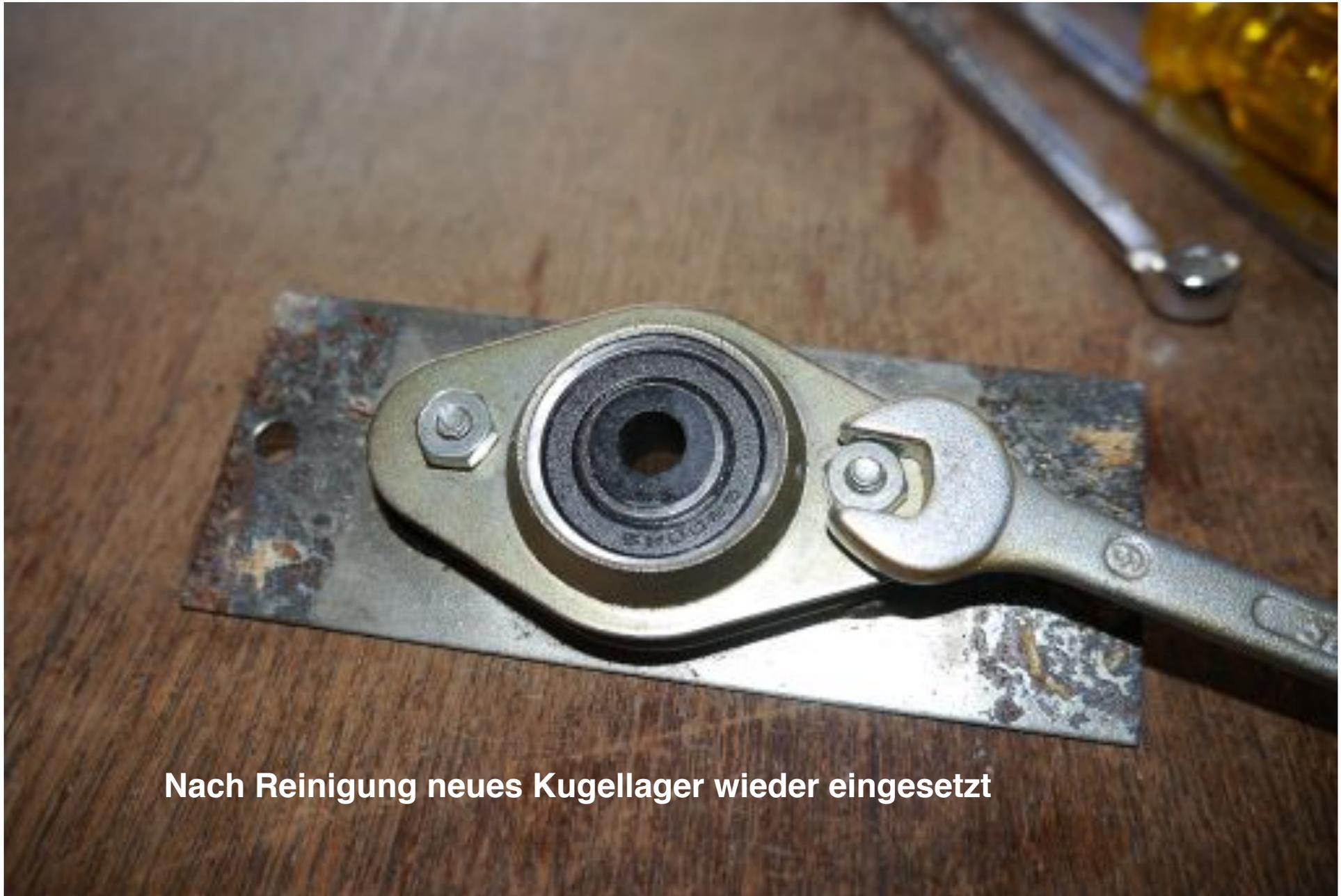
Nach Reinigung neues Kugellager wieder eingesetzt
