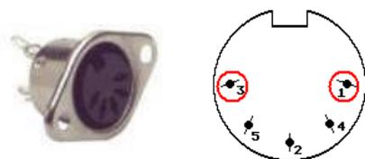
Es hat 5 Pins auf der Rückseite und einen sechsten, nicht verwendeten Erdungspin. Die 5 verwendeten Pins sind im Kreis wie folgt angeordnet: 3 – 5 – 2 – 4 – 1 . Die äusseren Pins 3 und 1 (rot markiert) werden für die 7.5-10 V Stromversorgung benutzt. Die anderen 3 Pins (5 - 2 - 4) werden direkt auf die zweite Buchse verkabelt (5 auf 5, 2 auf 2, ...)
