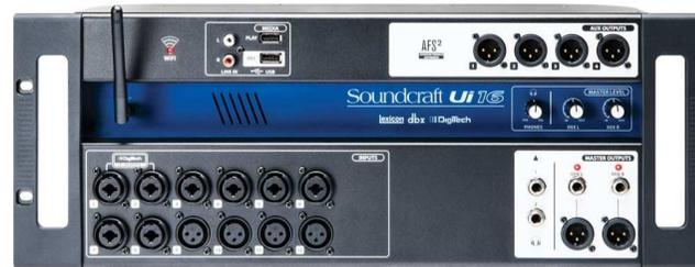
Der Mixer vergibt die IP-Adresse(n) für die Clients (Tablet/Laptop usw.); das UI hat dazu einen eingebauten „DHCP-Server“ – dieser ist in der Netzwerktechnik für die Vergabe der IP-Adressen zuständig.
