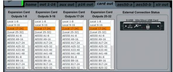
Auf AES A 01-08 werden die Aux In 01-06 zum FOH geschickt und über AES A 33-40 die Eingänge 01-16 des Pultes
